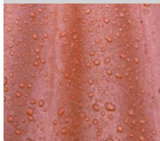
eine spezielle Beschichtung der Plattenoberfläche sorgt für einen „Abperleffekt“ des Regenwassers und somit für eine schnelle und saubere Trocknung der Dachfläche.
